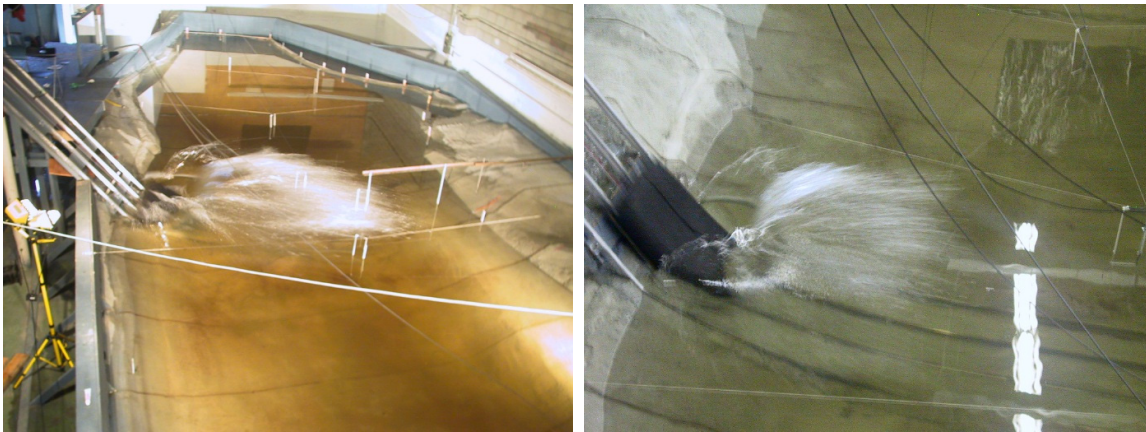
Figura 4.- Ejemplo de modelo físico de ondas causadas por deslizamientos en un lago (NHC 2005).
