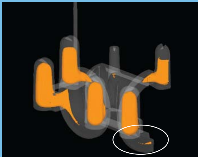
Рис. 3. Доля жидкой (незатвердевшей) фазы в разные моменты затвердевания отливки. Овалами выделены тепловые узлы отливки
