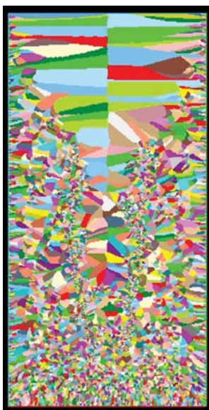
Рис. 4. Расчетная кристаллическая структура слитка из сплава Al+Si [2]
