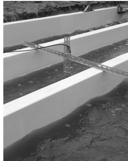
圖 3-15 流速計架設(二), 測量點(5)
