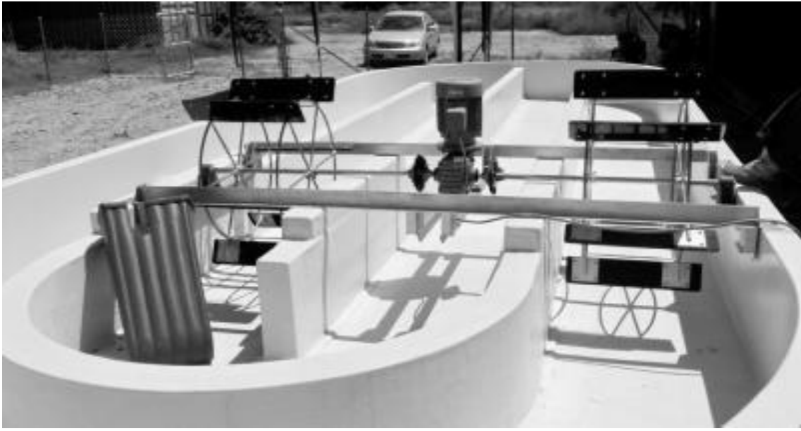
圖 4-35 成大微藻培養系統造流水車(晉弘強化塑膠公司)
